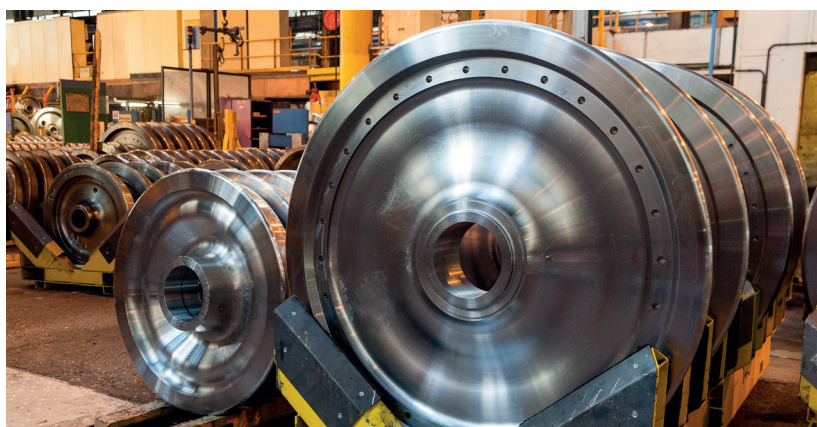
MG-Valdunes - Roue monobloc pour locomotive - crédit photo : Ludovic Ballet
