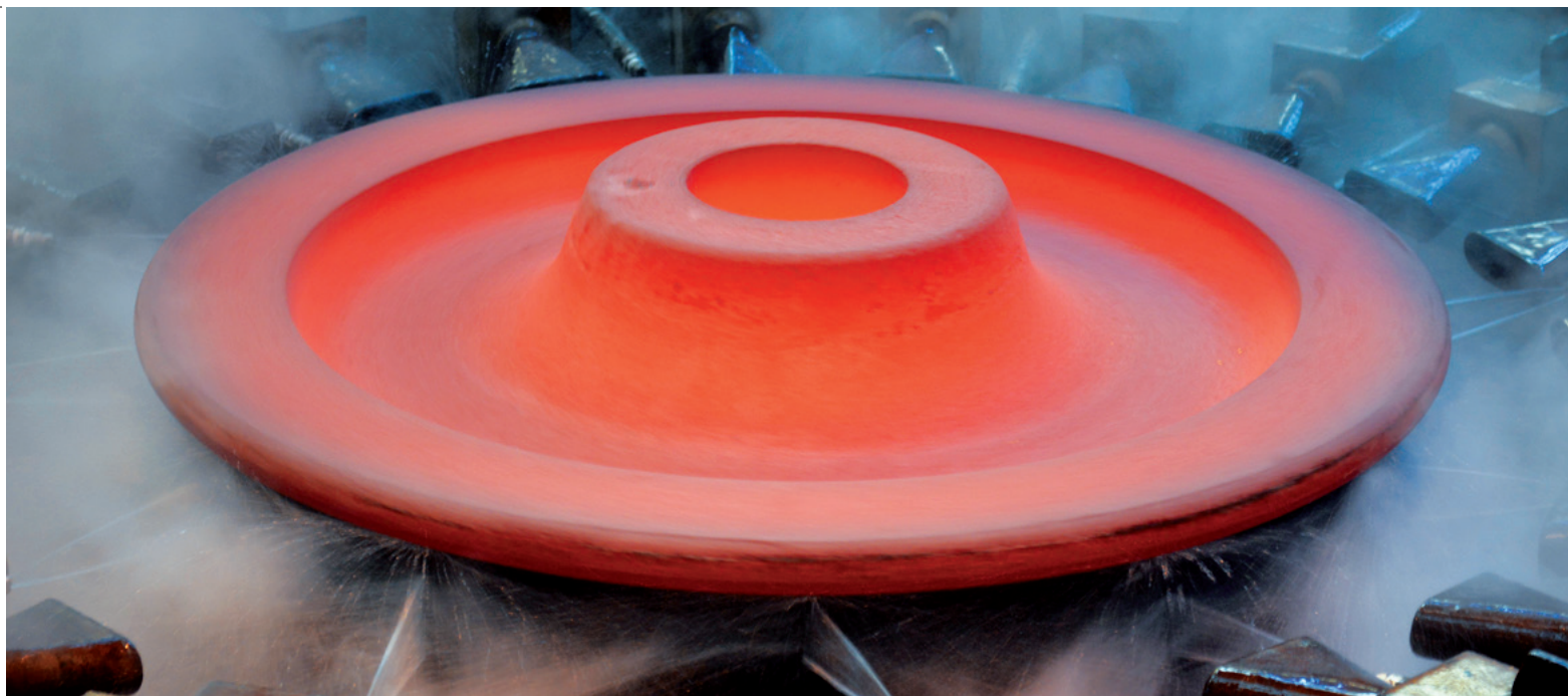
Traitement thermique roue après forgeage - crédit photo : MG-VALDUNES
