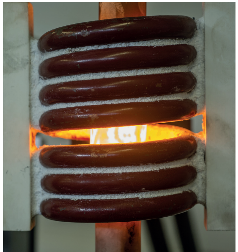
Chaufrage par induction de pièce - crédit photo : Université de Lille - Service communication
